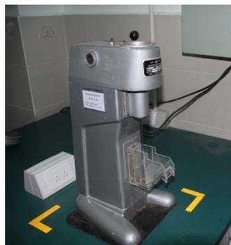
Fig. 3. Flotation cell
