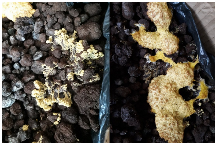
Fig. 6. Mold and fungus growth on damp UCG granulate (Kortnik, Anžič, 2026)
