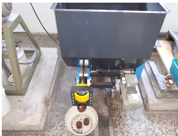
Fig. 5. MiniBrik-30 hydraulic briquetting machine (Kortnik, Anžič, 2026)
