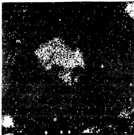
Rys. 9. Rozmieszczenie wapnia na powierzchni próbki z rys. 8. Powiększenie 480 razy
