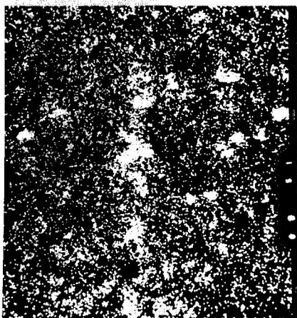
Rys. 14. Rozmieszczenie żelaza na powierzchni próbki z rys. 12. Powiększenie 960 razy
