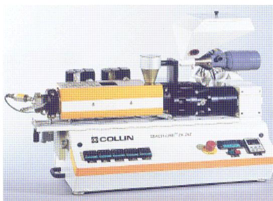
Fig. 1. ZK 25 T COLLIN Tischcompounder Extruder
